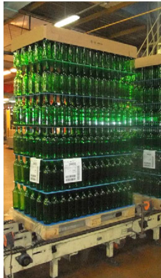
ge gelangt ist, wird vor der Anlage der angeheftete Barcode gescannt, der das Verpackungsschema beinhaltet. Nach der Verpackung wird die fertige Palette mittels eines Senkrechtförderers eine Etage tiefer dem Palettenbahnhof zugeführt.
